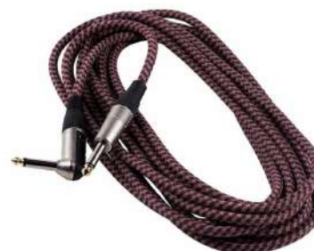
RCL 30256 TC H/BEIGE IVA INCL. € 14,00A RCL 30256 TC H/BEIGE - Cavo Strumento - Diametro Cavo: 7 mm - Jack pipa mono da 6,3 mm maschio + Jack dritto mono 6,3 mm maschio - Chassis connettore in plastica - Punta connettore placcata oro - Finitura: Telata - Colore: Beige - Lunghezza: 6 m.
