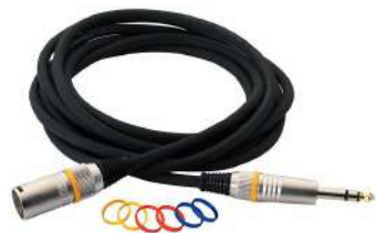
RCL 30383 D7 M BA IVA INCL. € 9,50A RCL 30383 D7 M BA - Cavo Bilanciato - Diametro Cavo: 7 mm - Jack dritto Stereo da 6,3 mm maschio + XLR maschio - Chassis connettore in metallo - Colore: Nero - 6 code rings in 3 colori - Lunghezza: 3 m.
